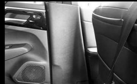
三菱 アウトランダーPHEV GN系 (インナーセンターピラー部)
